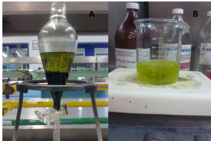
Figura 7. Extracción por método Röse-Gottlieb. A. Extracción por éter; B, Evaporación de solventes.
