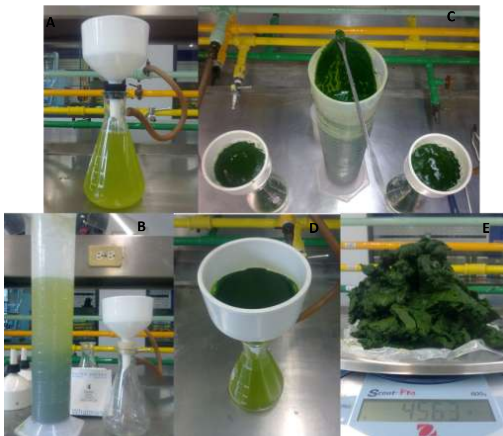
Figura 5. Obtención de biomasa para biodiesel. A. Sistema de filtrado; B. Sedimentado; C, D. Filtrado al vacío utilizando filtro de fibra de vidrio; E. Pesado de la biomasa 456.3 g.
