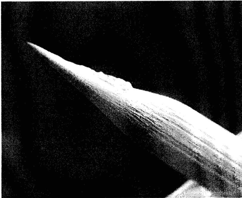
**Figura 20. Micrografía en SEM de una punta de tungsteno sin recubrimiento, con un aumento de 5000X y una resolución de 18  $\mu\text{m}/\text{cm}$ .**
