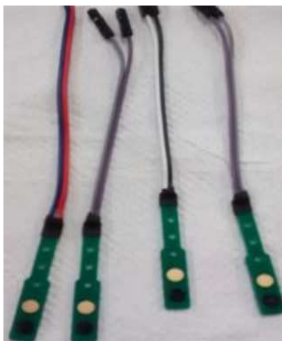
Figura 33. Electrodos de oro modificados.
