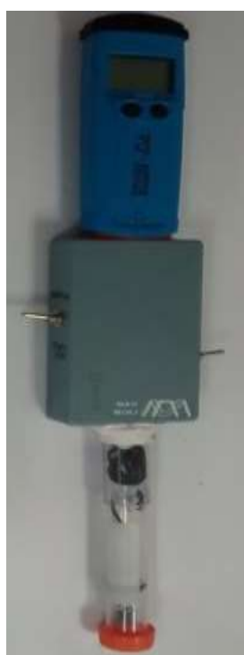
Figura 40. Conductímetro H19811 con NASEc.
