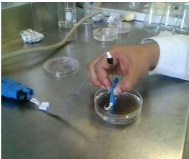
Figura 19. Medición de E. coli con los electrodos de grafito.
