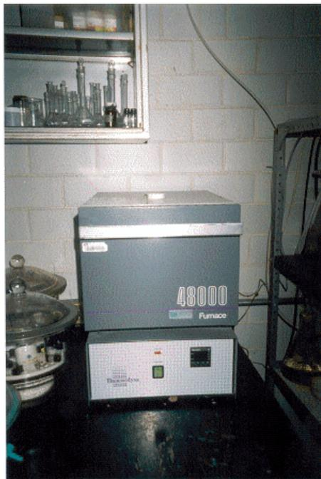
Fig. 3.4.2.1 Estufa para la calcinación de los óxidos mixtos
