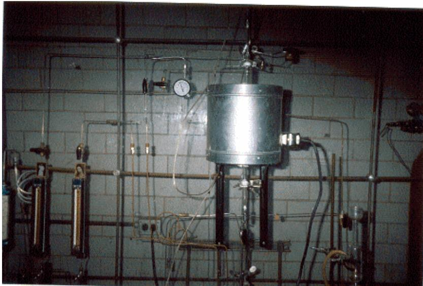
Fig. 3.4.2.4 Reactor de reducción de los catalizadores
