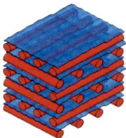
Fig. I-8 Esquema del andamio propuesto, en rojo material extruido, en azul material electrohilado.
