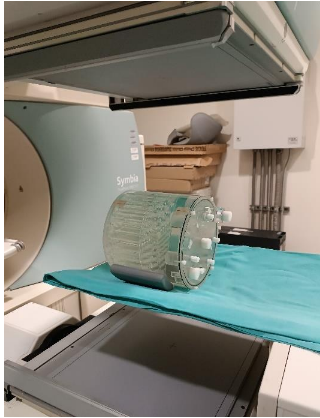
Fig. 23. Montaje experimental para la obtención del factor de corrección por efecto de volumen parcial.
