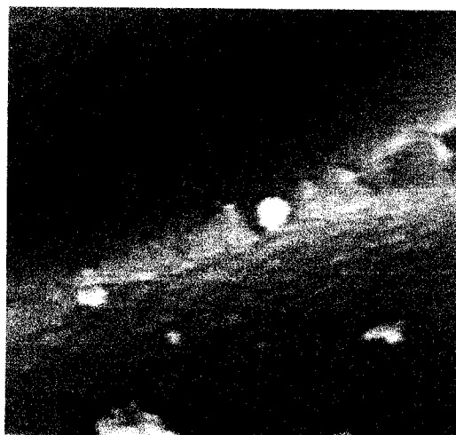
Figura 4.4-8B.- Microfotografía electrónica de barrido del soporte TiO 2 sol-gel, calcinado a 600°C/6 horas.
