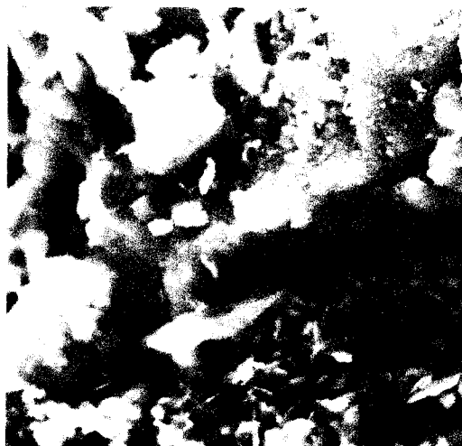
Figura 4.4-1C.- Microfotografía electrónica de barrido del soporte de \text{Al}_2\text{O}_3 precipitado a pH=10, calcinado a 600°C/6 horas.
