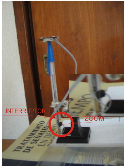
**Figura 3.7** – Apuntador de sistema de navegación inercial con el interruptor de detección de inicio y final del movimiento.
