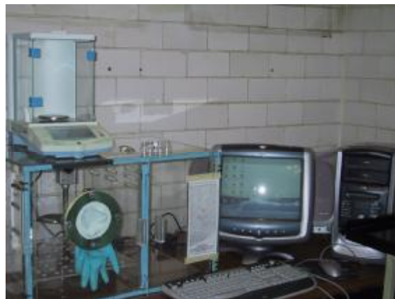
Fig. 2.- cámara con humedad y temperatura controladas
