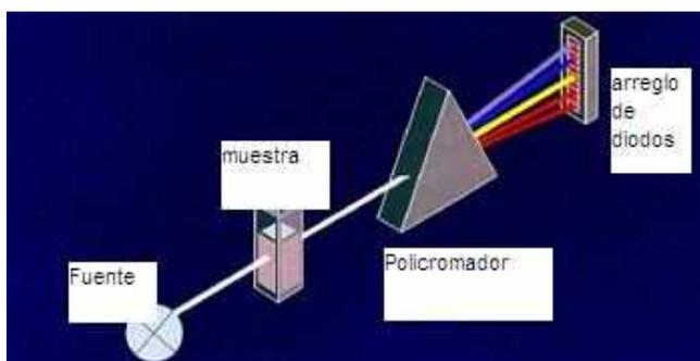
Fig. 10.- Fotodetector de arreglo de diódos (PDA)
