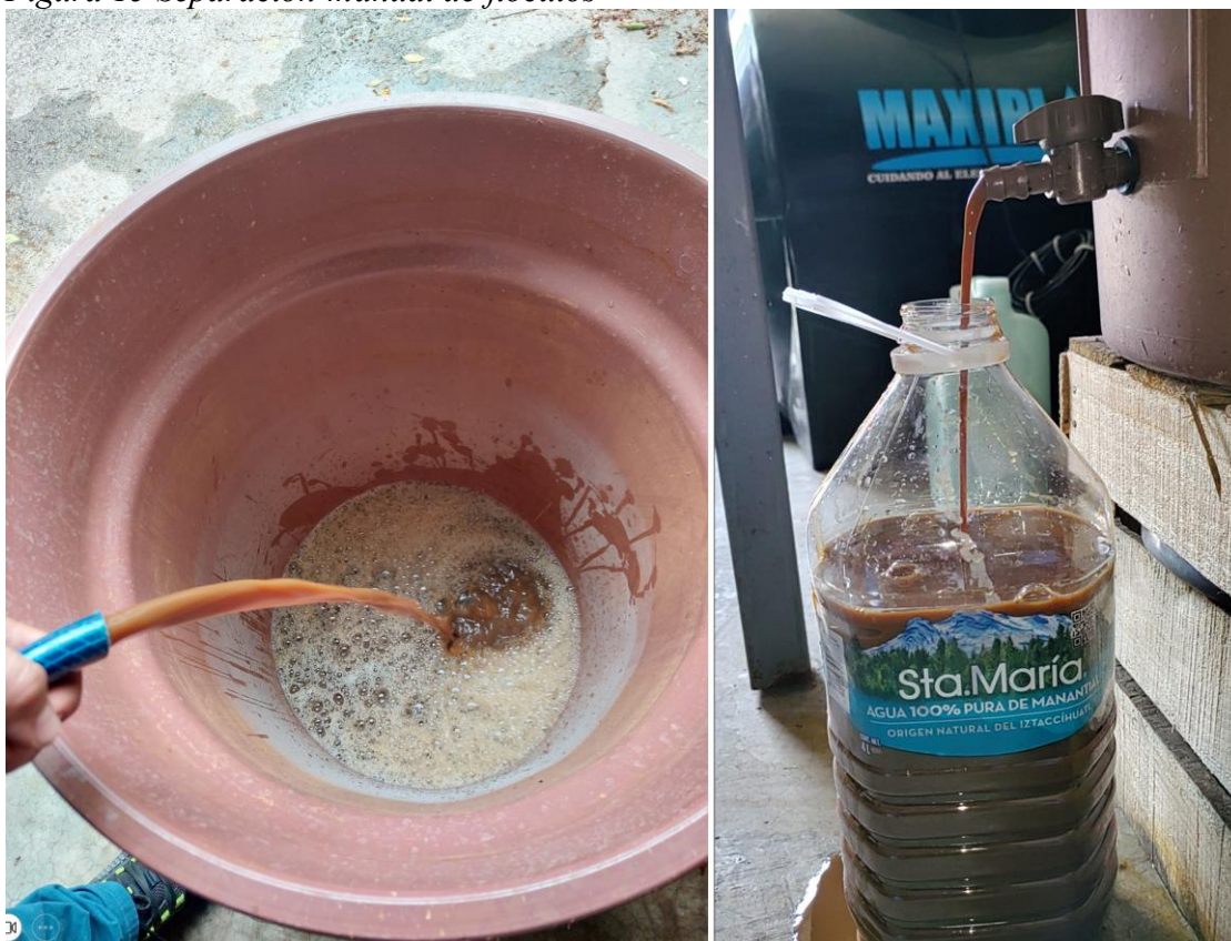
Figura 15 Separación manual de flóculos
