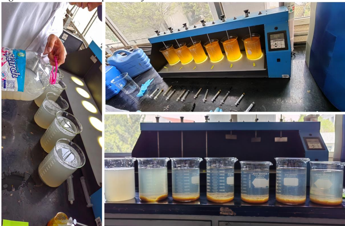
Figura 16 Elaboración de prueba de jarras
