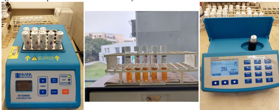
Figura 21 Multiparámetro COD HI83399 y termo reactor HI 839800
