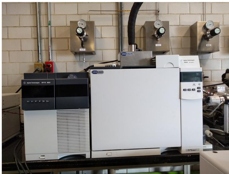
**Figura 5.5.** Cromatógrafo de gases Agilent 7820A, acoplado a un espectrómetro de masas Agilent 5977E MSD. Elaboración propia.
