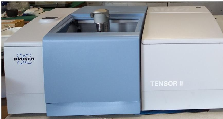
**Figura 5.3.** Espectrofotómetro infrarrojo Tensor II FTIR. Elaboración propia.
