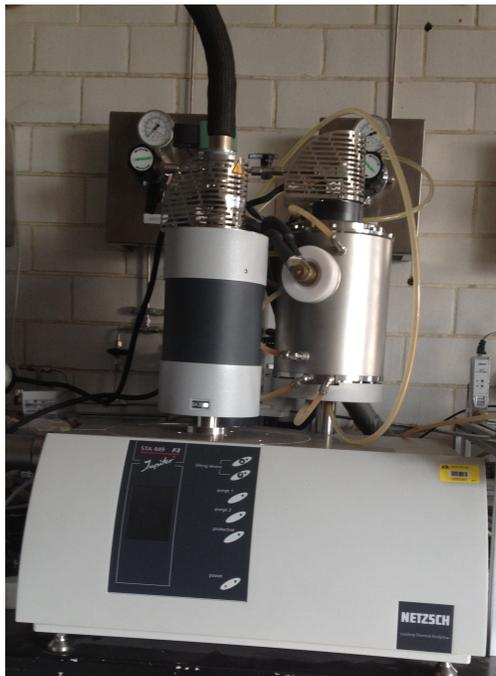
**Figura 5.4.** Analizador termogravimétrico STA449 F3, Jupiter. Elaboración propia.
