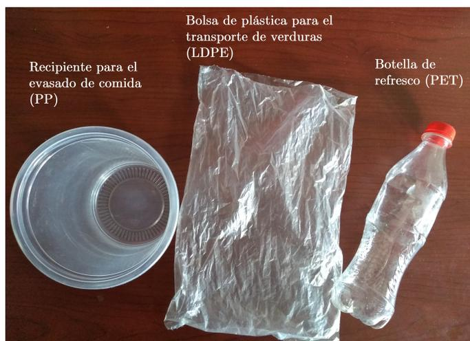
**Figura 4.2.** Residuos plásticos utilizados para su caracterización.
