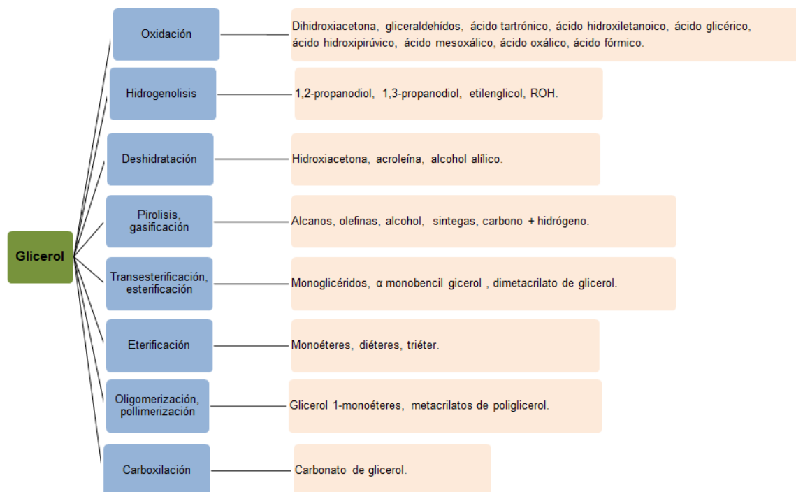
Figura 2. Reacciones para la conversión de glicerol a diferentes productos químicos con valor añadido.
