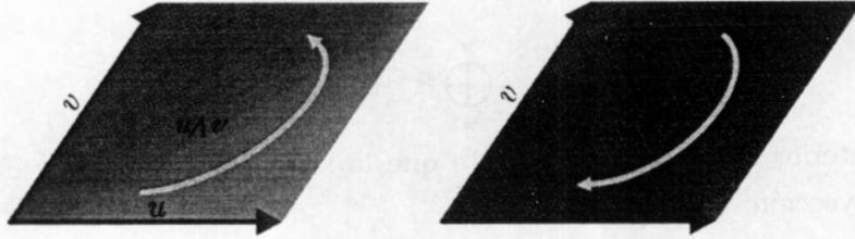
Figura 2 La interpretación geométrica del producto externo de dos vectores es el paralelogramo orientado generado por dos vectores. Geométricamente  $u \wedge v$  y  $v \wedge u$ , son dos paralelogramos congruentes pero con diferente orientación
