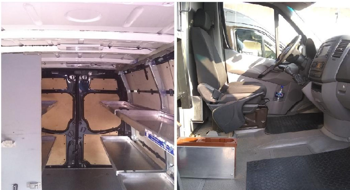
Caja y cabina de una camioneta de reparto. La cabina y la caja se encuentran separadas por una puerta corrediza de metal. Fotografía propia
