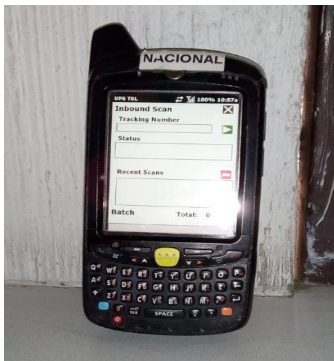
Imagen de escáner “Tundra” de entrada y salida de paquetes. Las dimensiones del equipo son: 16 cm de largo, 7 cm de ancho, profundidad de 3 cm y pesa 350 gramos. Fotografía propia.
