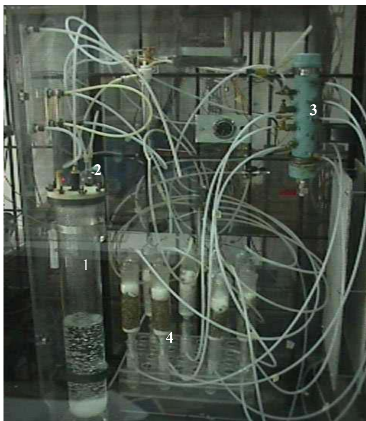
Figura 5.1. Sistema de biofiltros escala laboratorio (FMS). 1 Humidificador; 2 Evaporador; 3 Distribuidor de aire; 4 Columnas.
