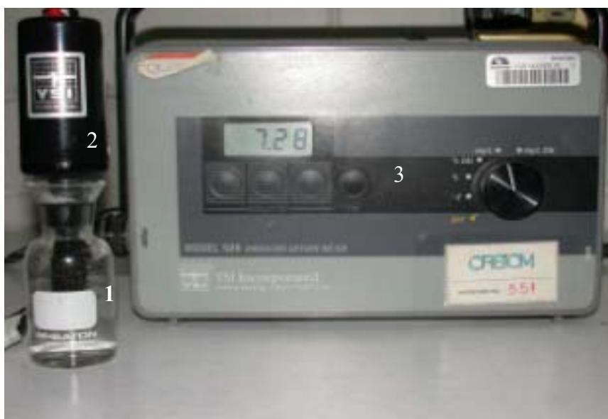
Figura 5.6. Sistema de análisis de consumo de oxígeno. 1 Botellas especiales de distintos volúmenes, 2 Electrodo tipo Clark que embona perfectamente en la boca esmerilada de las botellas. 3 Panel de control del dispositivo de medición de oxígeno disuelto (YSI 52).
