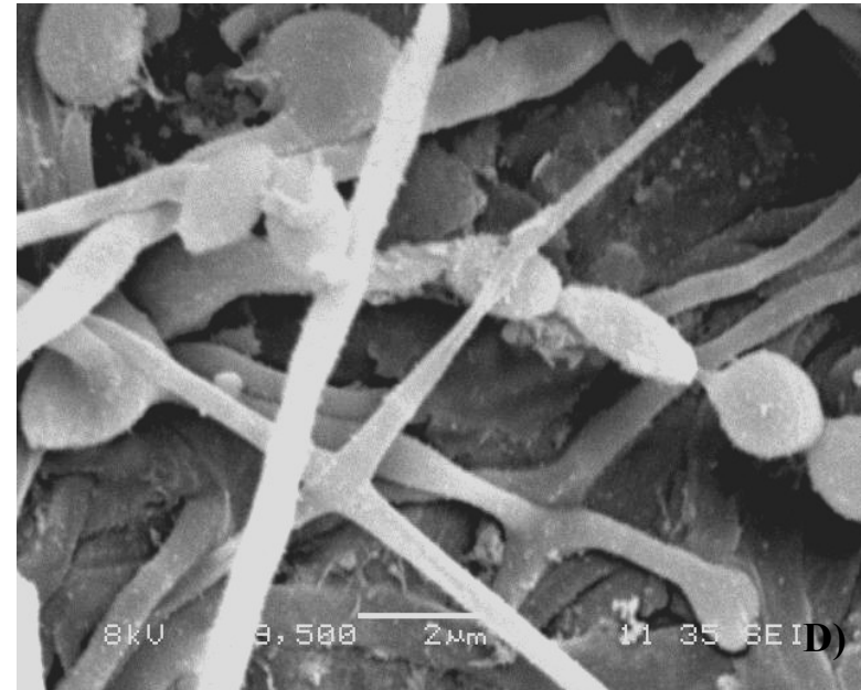
Figura 6.6.10. Fotografías de Microscopía Electrónica de Scedosporium apiospermum en vermiculita del biofiltro A) Antes de inoculación B) Crecimiento del microorganismo en el material de empaque C) Colonización del soporte D) Morfología característica.
