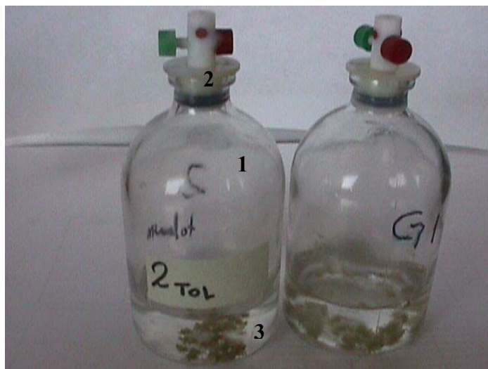
Figura 5.5. Sistemas de crecimiento en líquido con intermediarios. 1 Botella serológica. 2 Válvulas Mininert. 3 Medio de cultivo inoculado.
