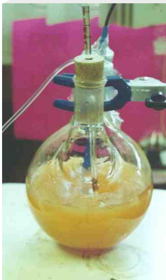
Figura 3.1 Esquema de la síntesis de los compuestos monometálicos tipo hidrotalcita de cobalto
