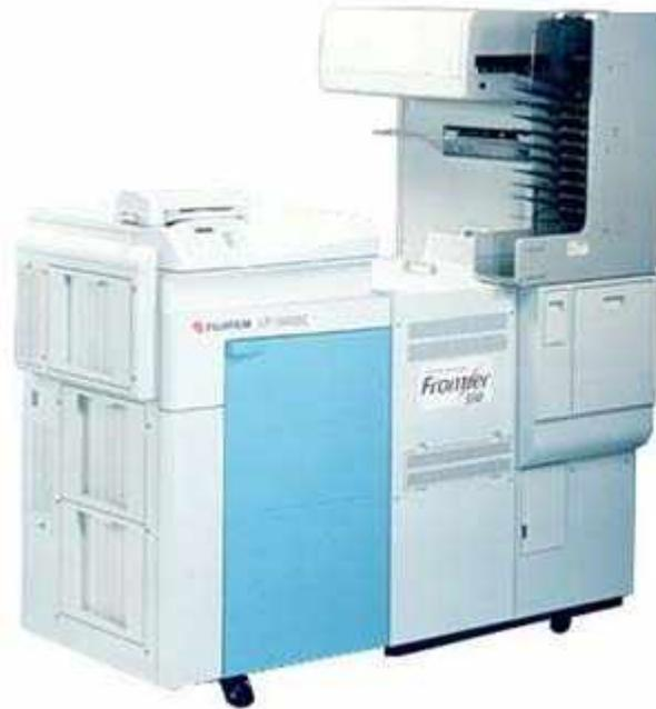
El minilab **Frontier Digital 350/370** de Fujifilm se adapta a este nuevo mundo, ya que combina la tecnología de haluro de plata y la digital. Película convencional, APS, cámaras digitales.
