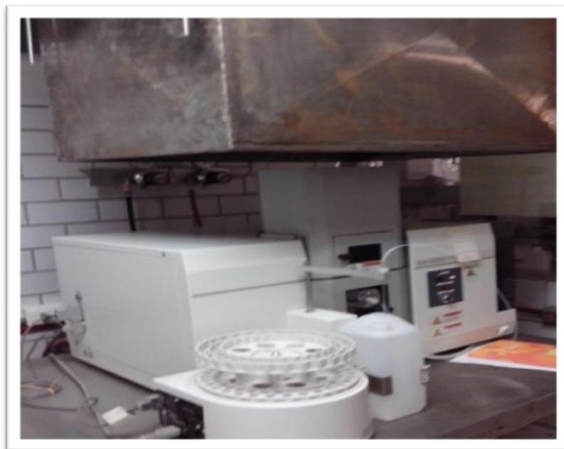
**Figura 8.** Espectrómetro de absorción atómica - SHIMADZU AA-6300
