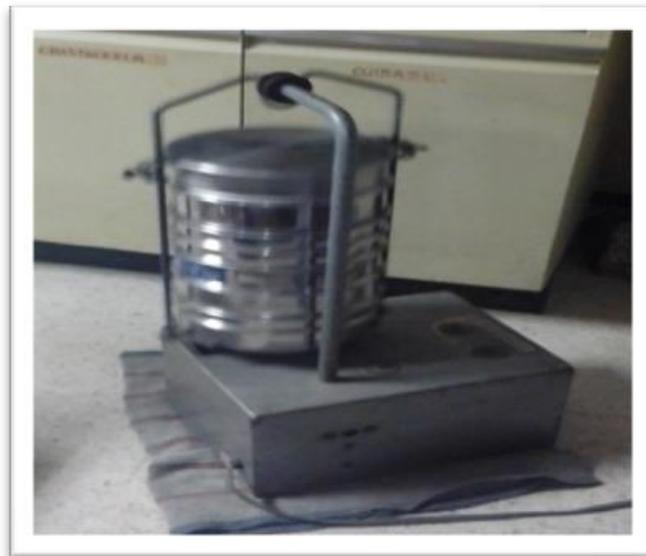
**Figura 6.** Tamizadora y tamices para el fraccionamiento de las muestras
