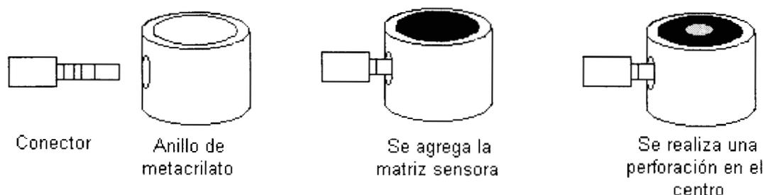
Fig. 29. Construcción del electrodo tubular diseñado para el sistema FIA.
