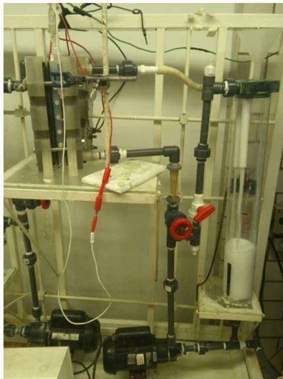
Figura 35. Reactor electroquímico FM01-LC, usado para llevar el pre-tratamiento del ARS+BGIS que posteriormente fue alimentada en el reactor de lodos activados.
