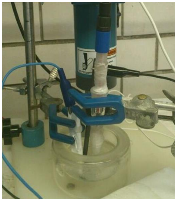
Figura 34. Celda típica de tres electrodos: BBD como electrodo de trabajo, barra de grafito como contra electrodo y electrodo de calomel como de referencia, para llevar a cabo las pruebas de microelectrólisis en agua residual sintética con y sin los fármacos BGIS
