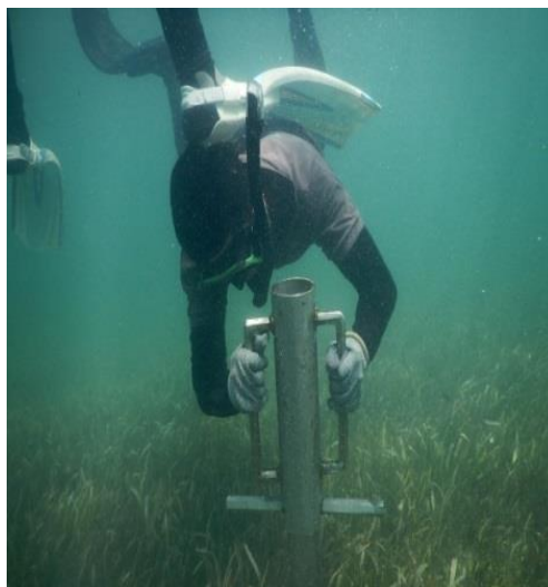
Figura 4. Extracción de la muestra de sedimento mediante un nucleador de acero inoxidable en la laguna Yalahau, Holbox, Q. Roo
