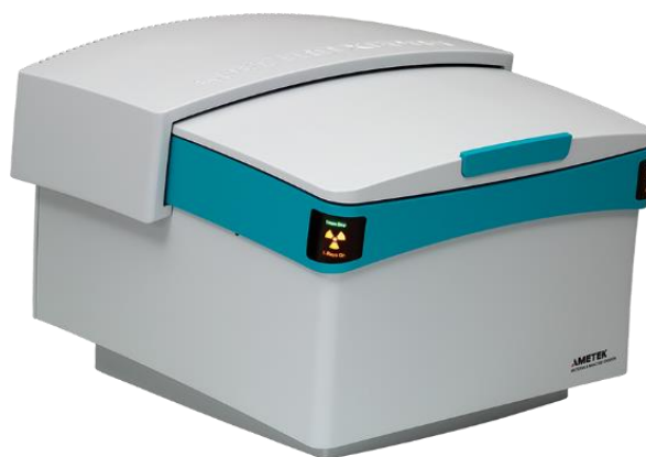
Figura 6. Sistema XRF Spectro Xepos 03 SLD utilizado para el análisis de composición elemental de los sedimentos del núcleo HX10
