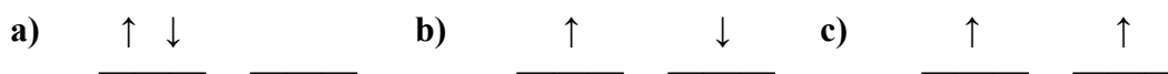
Figura 3.2. Representación esquemática de a) un sistema singlete (capa cerrada), b) un sistema singlete de capa abierta y c) un sistema triplete.
