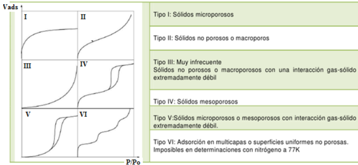
Figura 1.3 Clasificación de las isothermas de adsorción según la IUPAC. Las primeras 5 fueron propuestas por Brunauer, et al. (1938) [8,9], y es conocida como la clasificación BDDT.
