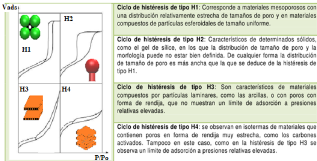
Figura 2.1 Ciclos de histéresis clasificados según la IUPAC [5,6], en cada figura podemos ver una figura representativa que puede generar un ciclo de histéresis como el que se muestra. Los puntos continuos representan la presencia de microporos, lo cual es común en este tipo de poros.
