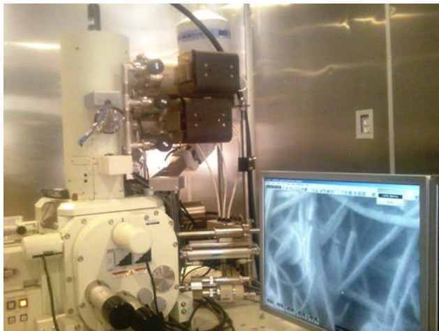
Figura 14. Microscopio electrónico de barrido de emisión de campo. FESEM – (Field Emission Scanning Electron Microscope). Este equipo fue usado en el análisis ultraestructural de las muestras de los NTCPM depositadas en distintas superficies.
