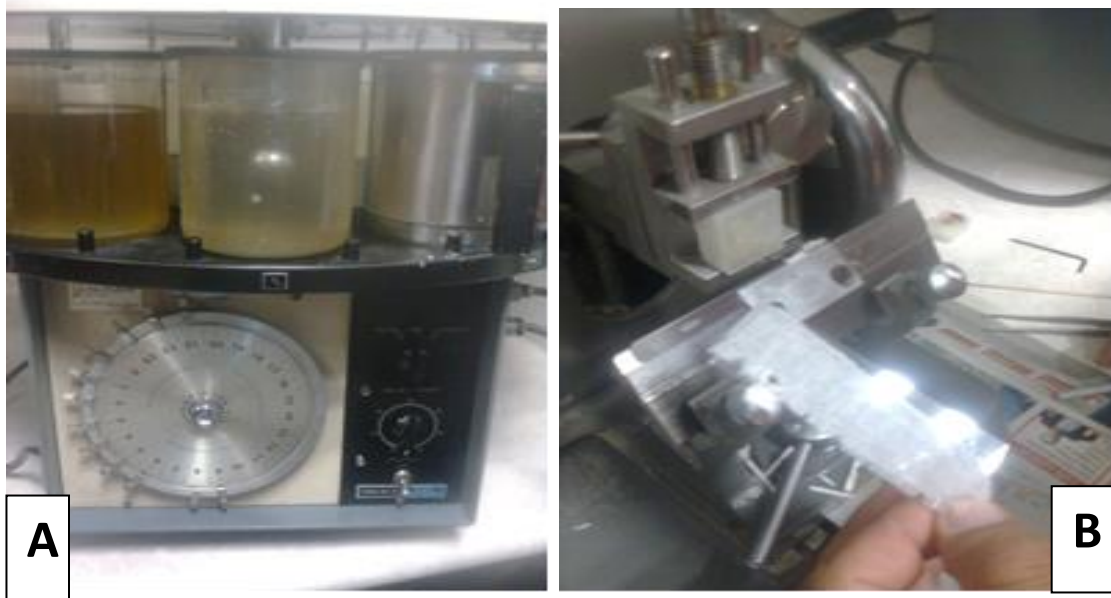
Figura 18. Histoquinette Lab-tek (A) y microtomo rotatorio manual marca Leica (B) para procesar y preparar cortes histológicos de las muestras del ganglio cerebral de Helix aspersa .
