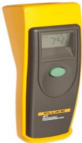
Figura 24. Termómetro Fluka-61-Infrared para medir los cambios de temperatura de los electrodos hechos con nanomateriales electroconductores.
