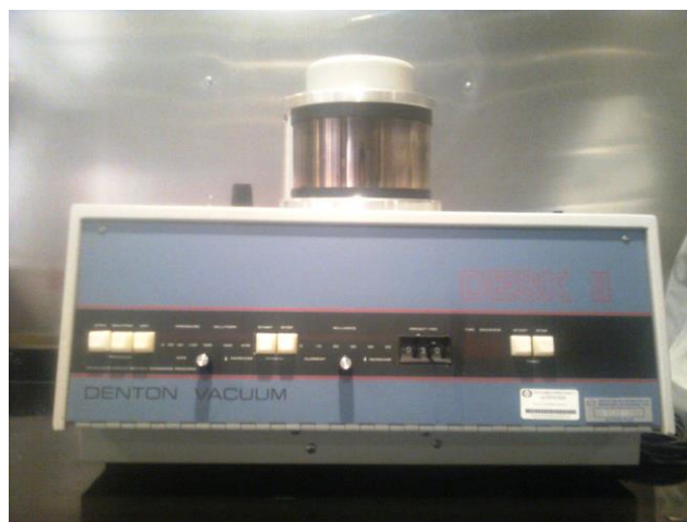
Figura 15. Equipo usado para la realización del baño con oro o plata, método de pulverización catódica o “sputtering” a las muestras de NTCPM.
