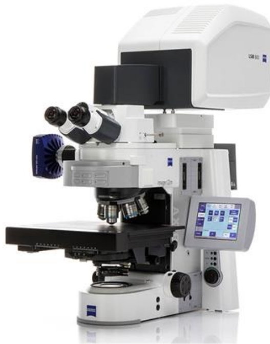
Figura 16. Microscopio confocal Carl Zeiss LSM 700, utilizado en este trabajo de tesis. Este equipo se usó en los experimentos para analizar las propiedades ultraestructurales de los NTCPM depositados en cubreobjetos de vidrio y sobre las neuronas de caracol.
