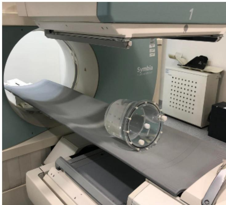
*Figura 15. Maniquí cilíndrico Flangeless Deluxe Jaszczak empleado para determinar el factor de calibración.*
