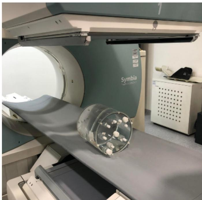
*Figura 16. Maniquí cilíndrico Jaszczak empleado para determinar el factor de corrección por volumen parcial.*
