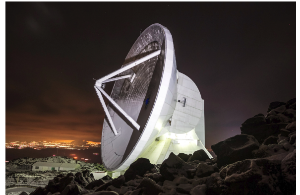
Figura 10: Izquierda: arreglo de telescopios milimétricos alrededor del mundo que componen el EHT y que se usó para observar la imagen de M87* en 2017. Imagen de NRAO/ESO disponible en https://www.eso.org/public/images/eso1907p/ . Derecha: Gran Telescopio Milimétrico (LMT, Large Millimeter Telescope ) ubicado en el volcán Sierra Negra en Puebla, México. El LMT opera entre 0.85\ mm y 4\ mm . Imagen del New York Times, disponible en https://www.nytimes.com/2015/06/09/science/black-hole-event-horizon-telescope.html .
