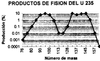
Fig. 1.4 Productos de la fisión nuclear del  $^{235}\text{U}$ .
