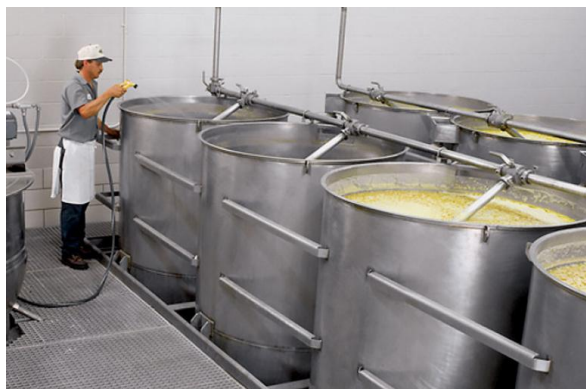
Figura 13: Remojo industrial de granos de maíz (Heat and Control,2025)
