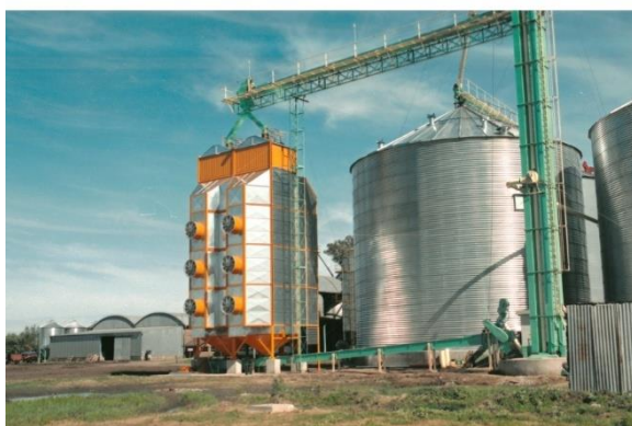
Figura 15: Secador y tostador industrial de granos (Dongy, 2025; Agrofy, 2025)
