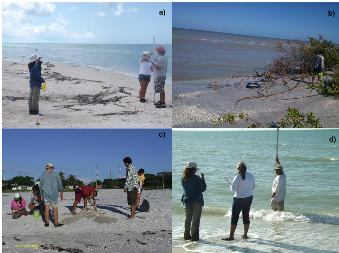
**Figura 4.6.** a) Toma de perfiles de playa, en el litoral de Campeche, b) Porción del litoral con manglar en recuperación, c) Recolección de muestras de sedimentos correspondiente al perfil muestreado y d) Toma del perfil topográfico donde se observa la rompiente de la ola corresponde a la zona de infraplaya.
