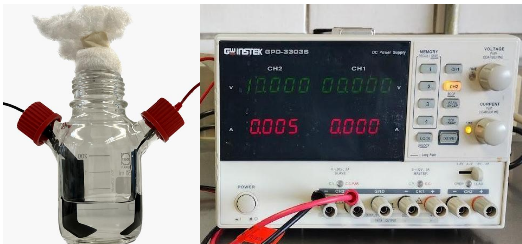
Figura 4. Reactor electroquímico con electrodos de titanio cubiertos con óxido de rutenio (izquierda) y fuente de poder (derecha).
