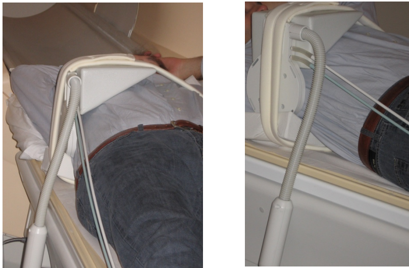
Figura A.1. Posicionamiento de la antena de fósforo para adquisición de espectro ^{31}\text{P} de hígado.
