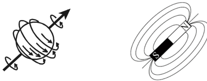
Fig. 3.1. Momento magnético nuclear y líneas de campo magnético generado.
