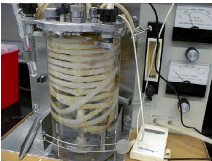
Figura 5. Reactor en lote de 2 litros con biomasa suspendida y suministro de aire por manguera de silicón, a temperatura ambiente, alimentado con MTBE como única fuente de carbono y energía. Fotografía de Morales y Deshusses 1999.
