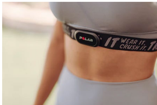
Figura 15. Posicionamiento del sensor POLAR en la parte superior del abdomen.
