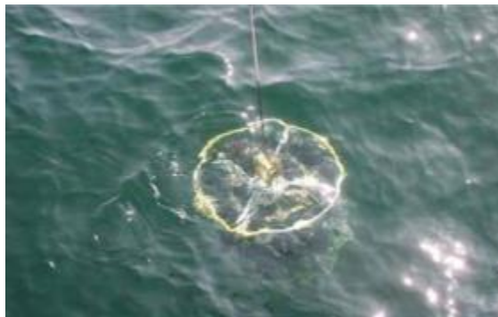
Figura 2.4. Sonda de conductividad-temperatura-profundidad (CTD, por sus siglas en inglés) en el mar Báltico para leer el perfil vertical local de las propiedades del agua de mar. (Feistel, 2012)
