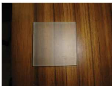
Figura 6.3. Vidrio sódico cálcico utilizado en la formación de láminas delgadas.
