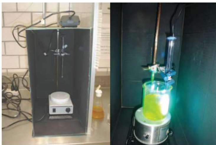
Figura 7.2. Fotorreactor Batch utilizado en los experimentos con los catalizadores soportados (láminas delgadas).
