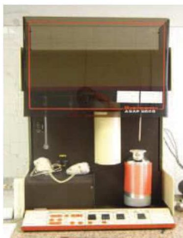
Figura. 3.4. ASAP 2000 Micrometrics para determinar áreas.
