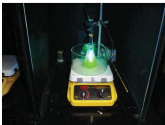
Figura 5.4. Fotorreactor Batch utilizado en los experimentos.
