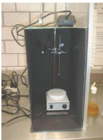
Figura 3.9. Fotorreactor para utilizado en las pruebas de actividad.
