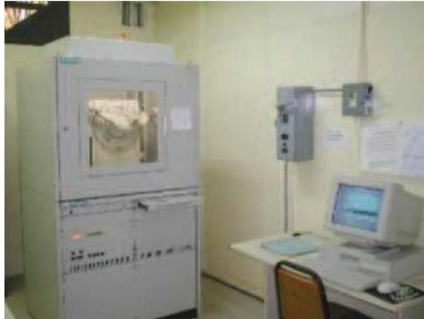
Figura. 3.2 Esquema de un difractor de rayos X SIEMENS D5000
