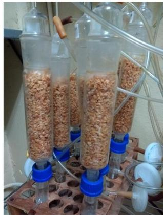
Figura 7-8 Columnas de vidrio de 17 x 5 cm (333.8 mL) utilizadas como biorreactores en CMS
