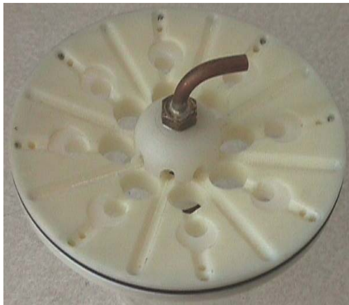
Figura 4.1.3 Redistribuidor colocados en cada módulo
