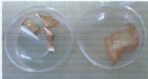
Figura 3.5 Andamios tratados superficialmente. Apariencia del Polivinil butier recubierto con pirrol del lado izquierdo fibra de poro cerrado y de lado derecho fibra de poro abierto
