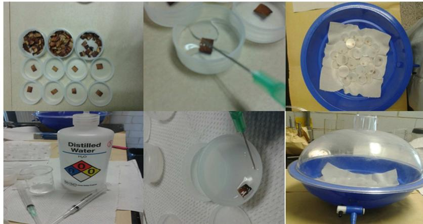
Fig. 16. Procedimiento para recubrimiento del material polimerizado con solución de agreganos.
