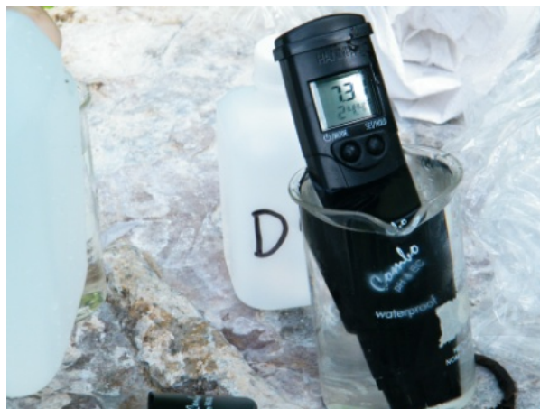
Figura 8. Calibrando con el potenciómetro HANNA
