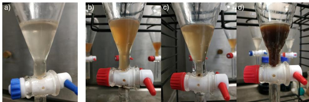
Figura 8.14: Materia orgánica disuelta después de una extracción líquida en suelo antes (a) y después de la imposición del campo eléctrico (zonas anódica (b), central (c), y catódica (d))
