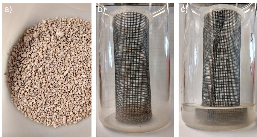
Figura A.2.2: Evaluación de la estabilidad de los agregados de suelo artificial a) muestra de suelo tamizada, b) muestra de suelo dentro del dispositivo de malla, y c) muestra dentro del dispositivo de malla sumergido en agua destilada
