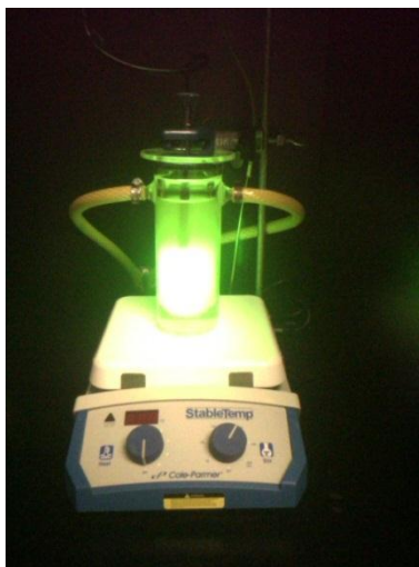
Figura 3.10. Sistema de reducción de 4-Nitrofenol.
