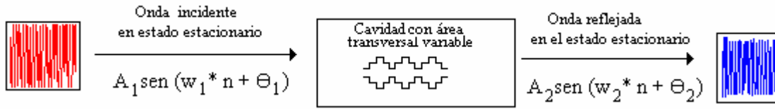
Figura 4.2.3.1.- La respuesta al impulso del sistema se obtiene a partir del estado estacionario
