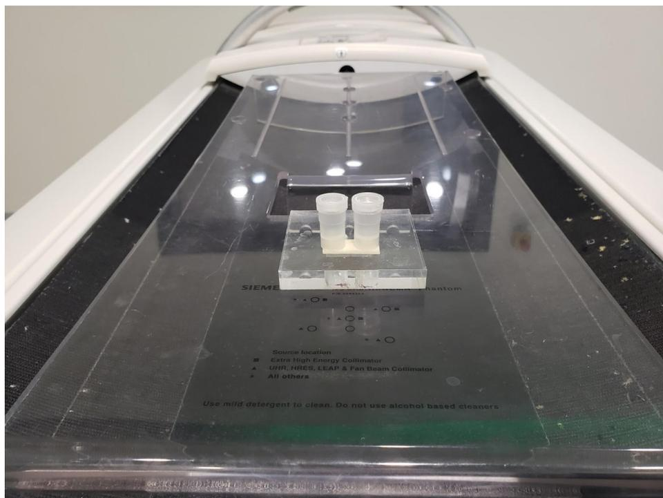
Figura 3-3: Montaje para la prueba de tiempo muerto.
