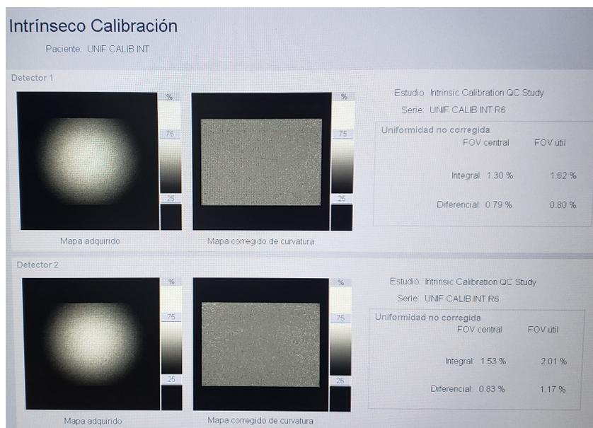
Figura 4-1: Imagen de uniformidad intrínseca adquirida con ambos detectores.
