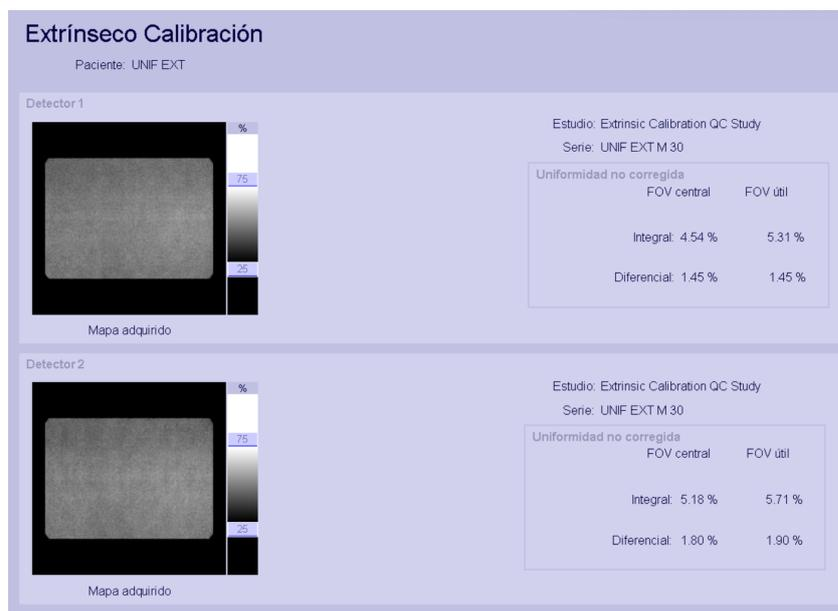
Figura 4-3: Imagen de uniformidad extrínseca adquirida con los colimadores ME en ambos detectores.
